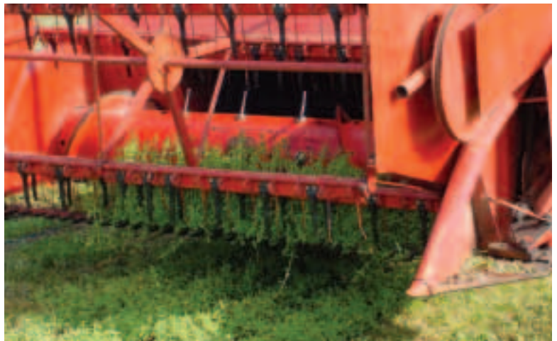
Foto 5. Ved maskinhøst af oregano er planterne så store, at der ikke er problemer med at få materialet over skærebordet med en almindelig vinde. Ved andre plantearter skal der måske monteres specielle børster (Foto Søs Kylling).
